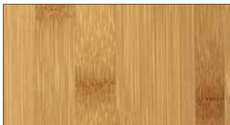
Omdat de persing gebeurt bij een hogere temperatuur, zal de kleur van gecompriëerde bamboe meestal donkerder zijn dan die van vloercomponenten uit verlijmden naturel strips
