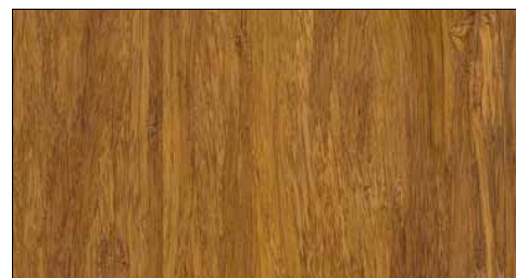
Omdat de persing gebeurt bij een hogere temperatuur, zal de kleur van gecompriëerde bamboe meestal donkerder zijn dan die van vloercomponenten uit verlijmden naturel strips
